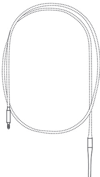
75-2128-22 Kunststoff-Sondenspitze Plastic probe tip Extremidad de sonda de plástico Punta in materia plastica
